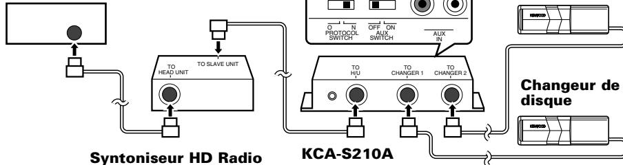
**!** Veiller à ce que l'extension totale du câble de commande allant de l'unité de commande au changeur de disque soit inférieure à 13 m. Les câbles de commande de plus de 13 m ne fonctionneront pas correctement.
